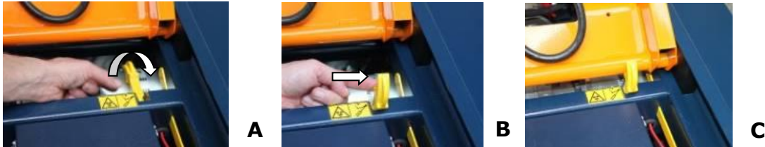
図 9.1 A-B-C;シザーブロックのロックを開ける
