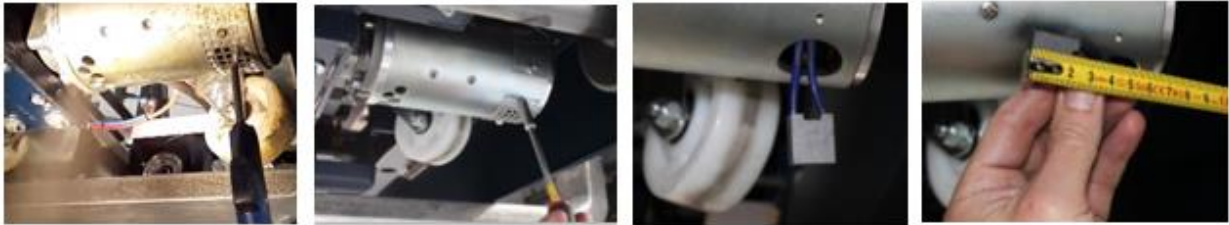
図 7.3 - モータ・カーボンブラシ検査
