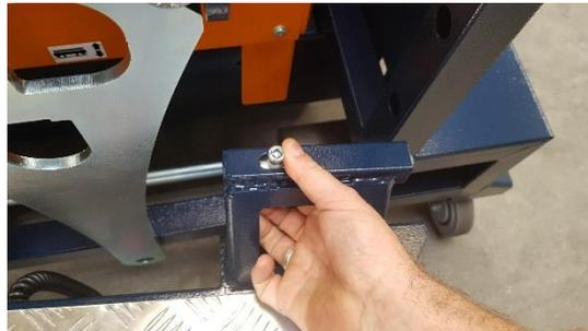
Introduzca una clavija en un agujero y luego presione hacia adentro la otra clavija como se muestra en la imagen, centre la clavija en el agujero y suelte la clavija desbloqueada.
