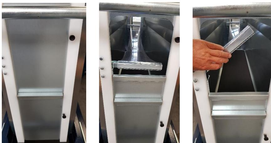
El contenedor de cosecha tiene escotillas ajustables en altura y una protección contra caídas de pimientos. La protección contra caídas se inclina hacia arriba cuando se descarga el contenedor, reduciendo en gran medida la posibilidad de que queden atrás algunos pimientos.
