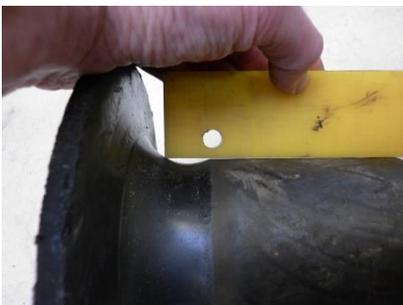
Un desgaste de 2-3 mm supone que las ruedas están bien. Mantenimiento normal, inspección de cuerdas alrededor. Aún no es necesario el reemplazo de las ruedas.
