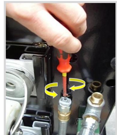
Figuur 7.4; Afstellen van de druksensor
