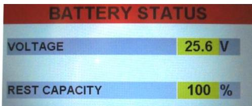
Sulla schermata dello stato **BATTERIE** è possibile visualizzare lo stato delle batterie. L'indicazione 100% indica batterie cariche, minore è la capacità residua indicata, minore è lo stato di carica delle batterie.
