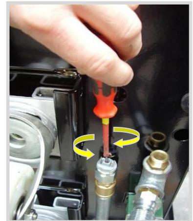
*Figura 7.4: Regolazione del pressostato*
