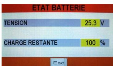
Sur l'écran « ETAT BATTERIE », vous pouvez contrôler la charge des batteries. À 100%, les batteries sont en pleine charge, plus la charge restante est basse plus les batteries sont déchargées.
