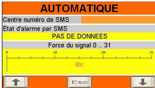
Lorsque vous appuyez sur la flèche vers le bas dans un écran AUTOMATIQUE, l'écran d'indication du modem ci-dessus apparaît. La force du signal doit être supérieure à '20' pour pouvoir envoyer des messages de manière fiable.
