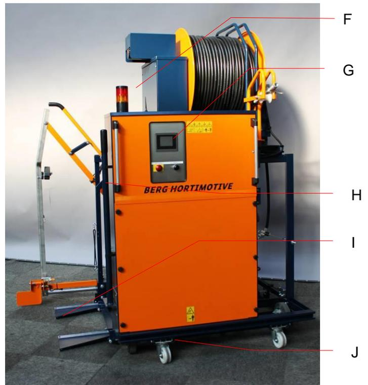
Abbildung 5.2: Vorderseite MetoTrans mit Führungsarm
