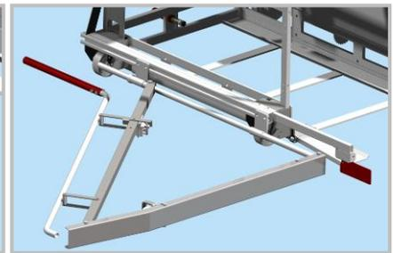
Abbildung 7.3; MetoTrans mit Führungsarm und Erkennungsflosse
