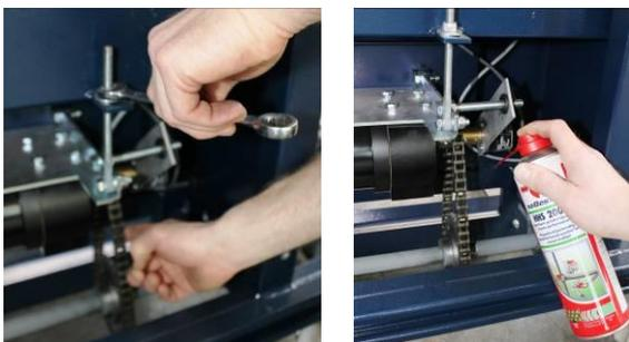
Reinigen Sie Ketten, Zahnräder und Rollen und entfernen Sie Einlaufseile und Blätter (wenn nötig).
