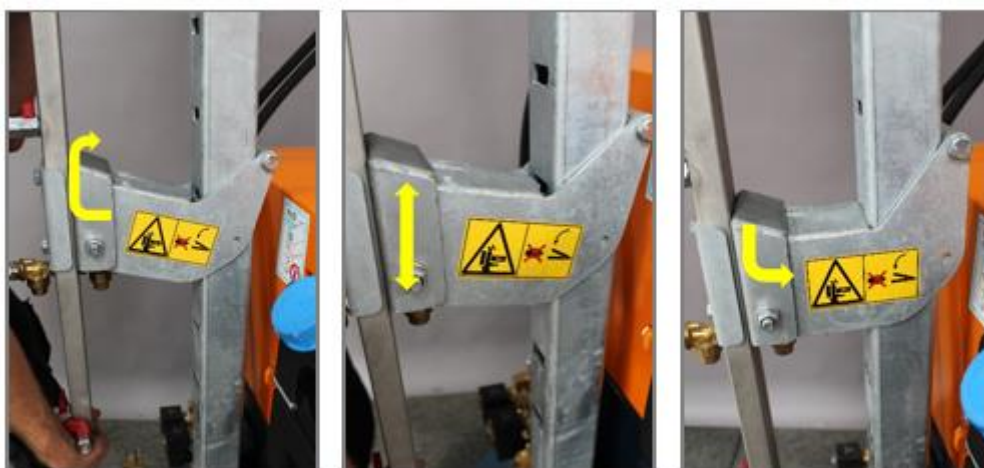
Рисунок 7.2 Регулировка опрыскивательной стрелы
