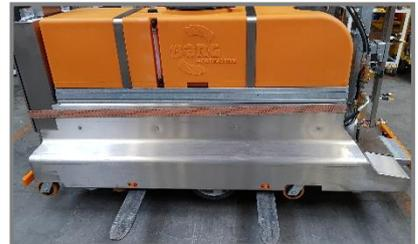
用叉车货叉在指定位置升起 *METO-SWT*，用结实的拉带将 *METO-SWT* 固定在叉车的货架上。
