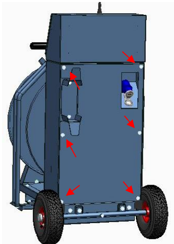
Figuur 9.4; Invetten van geleiderketting en trommellagers
