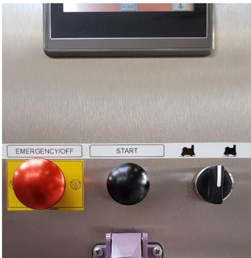
Для активации подъемника поверните ручку вправо. Переместите *МЕТО* и поверните ручку влево для полного опускания подъемника; при этом послышится звуковой сигнал.
