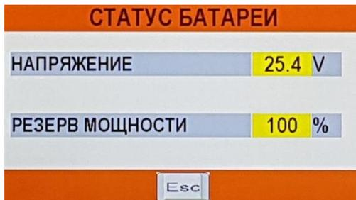
Экран показывает напряжение батареи в вольтах и отображает остаточную емкость в %.
