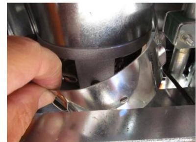
Снимите крышку щеток с помощью 8-мм ключа.
