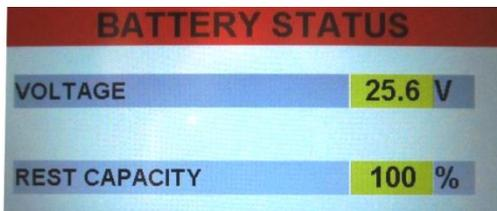
На экране ЗАРЯД БАТАРЕЙ можно проверить уровень зарядки. 100% означает, что батарея полностью заряжена; чем ниже остаточная емкость, тем ниже уровень зарядки батарей.
