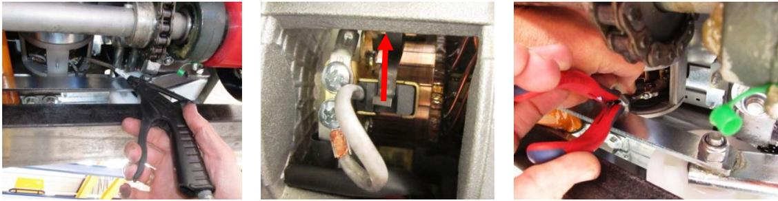
1) Pulire il motore con aria compressa (a secco). 2) Rimuovere la molla della spazzola 3) ed estrarre la spazzola di carbone dal supporto tirandola dalla filettatura.
