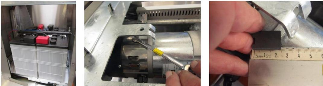
Riportare il *METO* sul pavimento, rimuovere le batterie e ripetere la procedura per le 2 spazzole di carbone sul lato superiore del motore.
