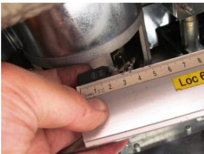
Un balai de carbone de moins d'un centimètre de long doit être remplacé, consultez votre revendeur.
