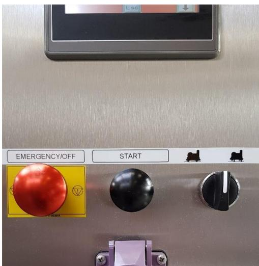
Tournez le bouton vers la droite pour activer le système d'annulation. Déplacez le *METO* et tournez le bouton vers la gauche pour laisser le système d'annulation entrer complètement jusqu'à ce qu'un bip retentisse.
