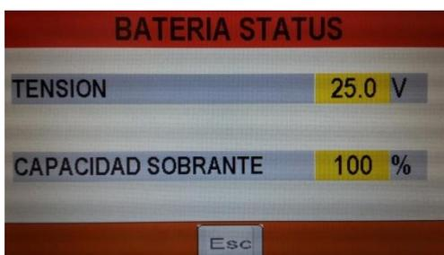
La pantalla muestra el voltaje de la batería en voltios e indica la capacidad restante en %.
