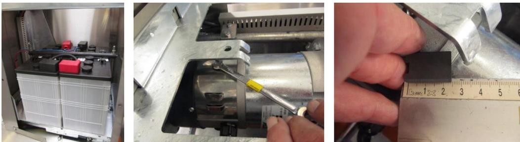
Coloque la *METO* con cuidado en el suelo, retire las baterías y repita las operaciones anteriores para los dos cepillos situados en la parte superior del motor.
