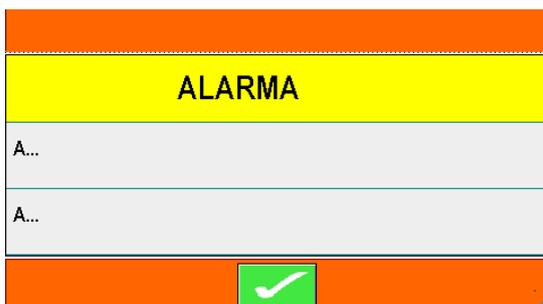
Durante el funcionamiento automático, en la pantalla pueden aparecer mensajes de error. Restablezca estos mensajes manteniendo pulsada la tecla que tiene una marca de verificación verde.
