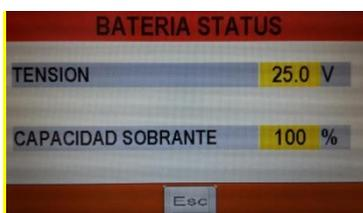
En la pantalla de ESTADO DE LA BATERÍA puede comprobar el estado de las baterías. Al 100 % las baterías están llenas, como menor sea la capacidad residual más descargadas estarán las baterías.
