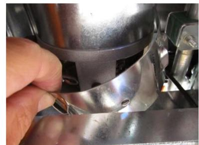
Retire la tapa de la escobilla con una llave inglesa de 8 mm.
