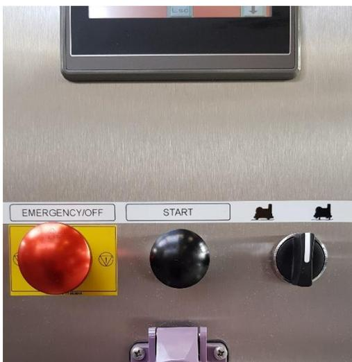
Drehen Sie den Knopf nach rechts, um das Löschesystem zu aktivieren. Bewegen Sie den *METO* und drehen Sie den Knopf nach links, um das Löschesystem vollständig einzuschalten, bis ein Piepton zu hören ist.
