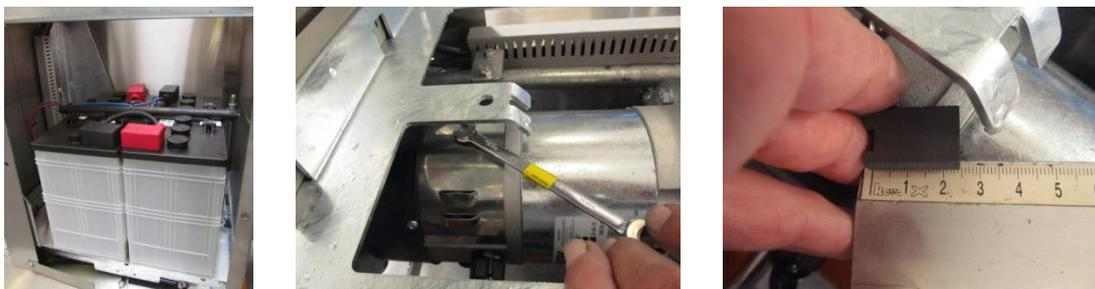
将 *METO* 小心放到地上，取出电池，并对发动机顶部的两个刷子重复上述操作。
