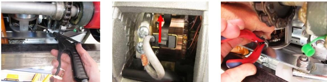
1) 用（干燥）空气吹净发动机。2) 松开刷子弹簧。3) 然后将刷子从支架上拉出。
