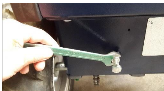
Figuur 9: Losdraaien/ aandraaien blokkeermoer
