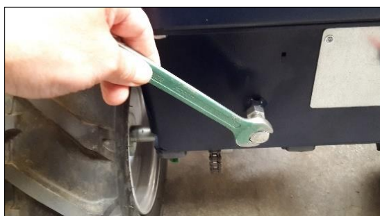
Figuur 10: Spannen ketting
