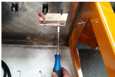
Pak een plateau (Pakket B) leg deze op een stuk karton en demonteer de bouten.
