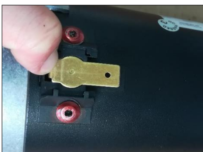
Figuur 5d & e: Koolborstels monteren
