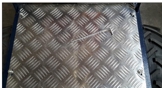
Figuur 7: Traanplaat de- monteren
