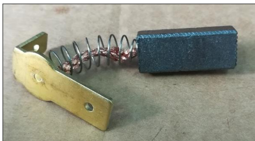
Figuur 5d: Koolborstels inspecteren
