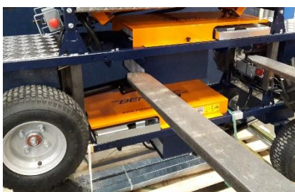
Verwijder verpakking en ontstapel de EasyTrack onderwagens. (Pakket A)
