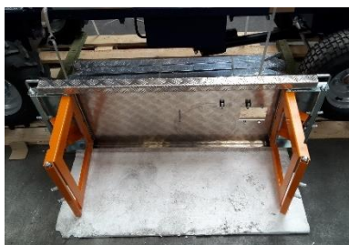
Pak een plateau (Pakket B) leg deze op een stuk karton en demonteer de bouten.
