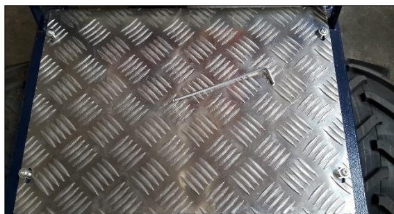
Figure 7 : Démontage de la tôle striée
