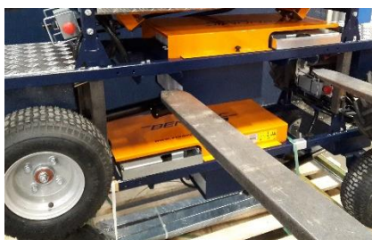
Retirez les emballages et désempilez les trains de roulement EasyTrack. (Paquet A)
