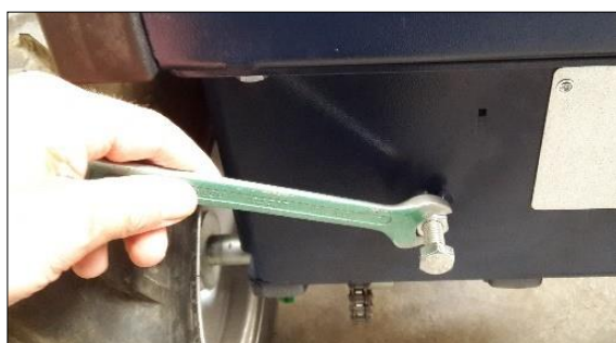
Figure 9 : Desserrage/serrage de l'écrou de verrouillage
