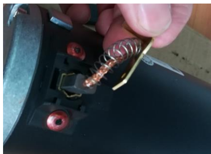
Figures 5b et c : Nettoyage et inspection des balais de carbone
