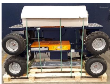
Retirez les emballages et désempilez les trains de roulement EasyTrack. (Paquet A)
