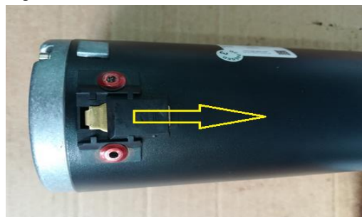
Figures 5b et c : Nettoyage et inspection des balais de carbone
