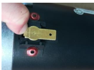
Figures 5d et e : Montage des balais de carbone
