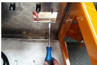
Prenez la plateforme (paquet B), posez-la sur un morceau de carton et dévissez les boulons.
