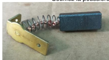
Figure 5d : Inspection des balais de carbone
