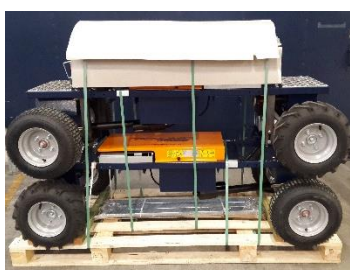
Rimuovere la confezione ed estrarre i carrelli inferiori di EasyTrack . (Pacchetto A)
