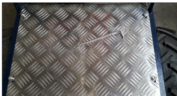
Figura 7: Smontare la lamiera striata
