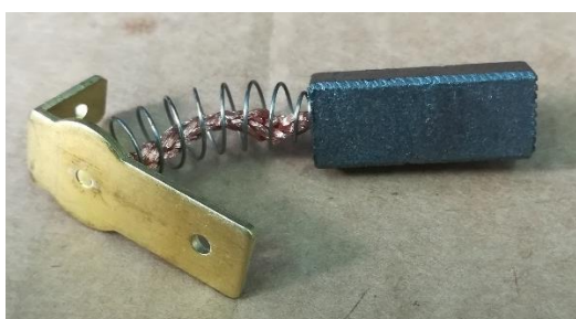
Figura 5d: Ispezionare le spazzole di carbonio
