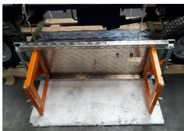
Appoggiare una piattaforma (Pacchetto B) su un cartone e svitare i bulloni.
