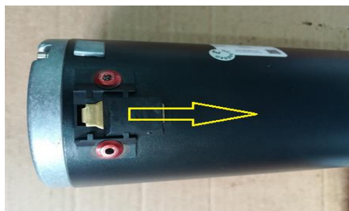
Figure 5b e 5c: Pulire e ispezionare le spazzole di carbonio
