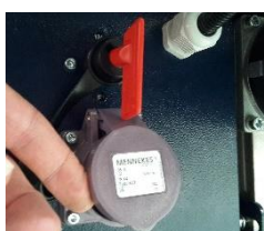
A Interruttore principale ON
