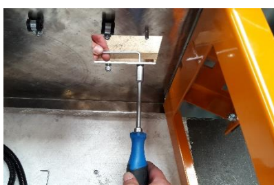
Appoggiare una piattaforma (Pacchetto B) su un cartone e svitare i bulloni.
