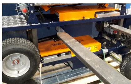
Rimuovere la confezione ed estrarre i carrelli inferiori di EasyTrack . (Pacchetto A)
