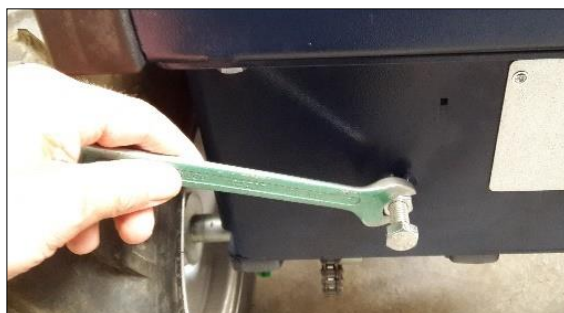
Figura 9: Allentare/serrare il dado di bloccaggio
