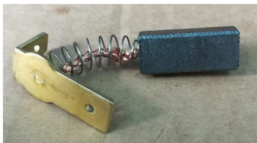
Figura 5d: Inspección de las escobillas de carbono
