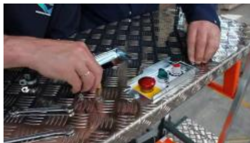
plaats de bedienkast en schroef deze vast
