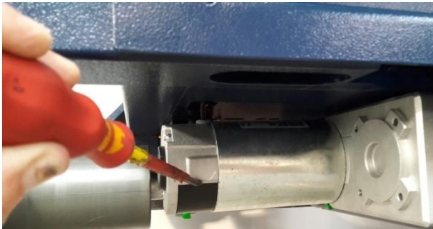
Figuur 5a: Koolborstels inspecteren reinigen
