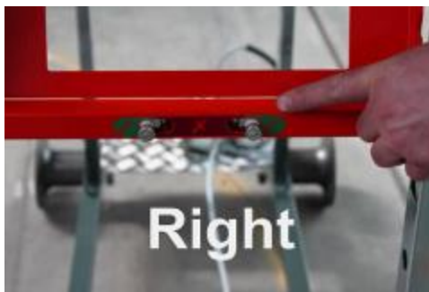
beide bouten moeten in het groene gedeelte zitten
