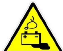
Опасная химическая батарея: взрывоопасные газы и агрессивные кислотные аккумуляторы
