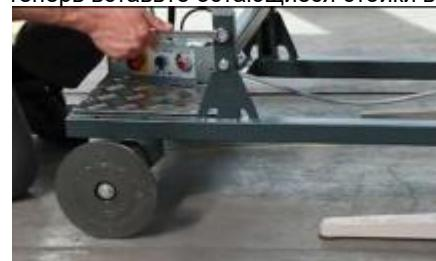
закрепите стойки, затянув болты
