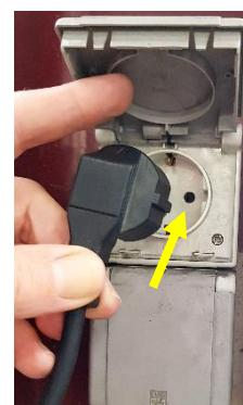
4. После того, как зарядный разъем подключен к зарядному устройству, включите зарядное устройство в розетку. Батареи теперь будут заряжаться.
