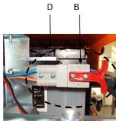
Рисунок 4. Заземляющий выключатель
