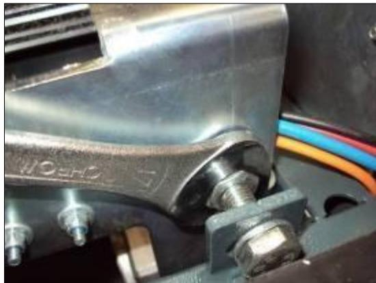
Рисунок 6: Раскручивание / затягивание зажимной гайки
