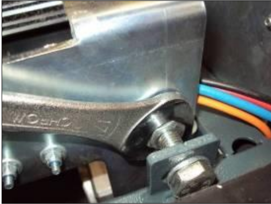
Figura 6: Aflojar/apretar la tuerca de bloqueo
