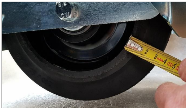
Figuur 15: Controle op slijtage, meet voorbeeld
