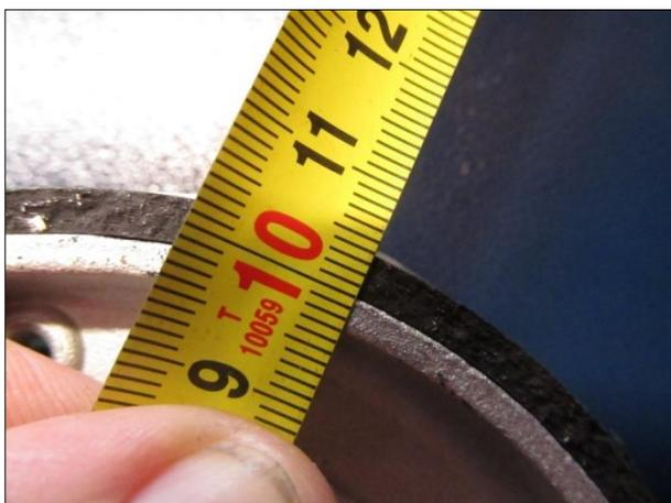
Рис. 11. Измерьте толщину тормозной колодки
