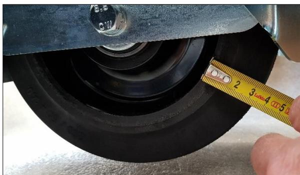
Рис. 15. Проверьте износ, пример измерения
