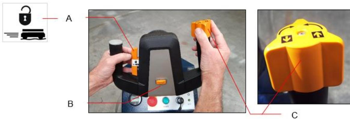
Рис. 3: Рулевое управление BeTrac 1 AGV
