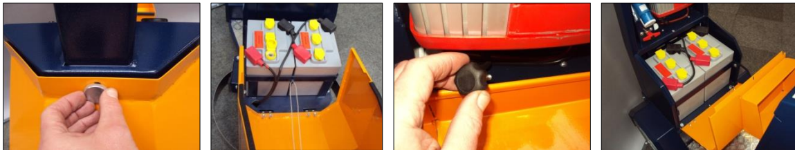
図 12: バッテリー・メンテナンス
