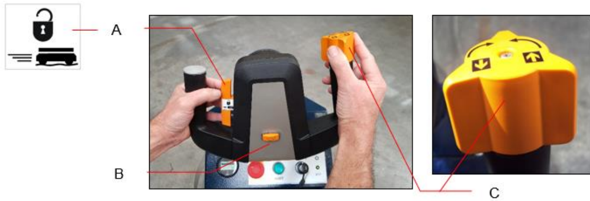
図 3: BeTrac 1 AGV のステアリング制御
