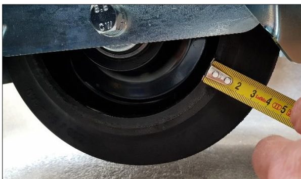
図 15: 摩耗をチェックします。測定例
