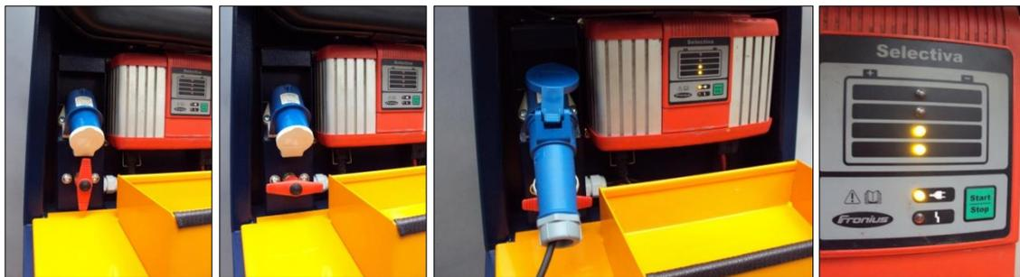
Figura 7: Istruzioni per la ricarica
