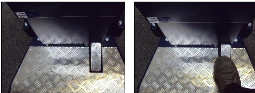
Figura 4: Pedale del freno dell'unità BeTrac 1 AGV
