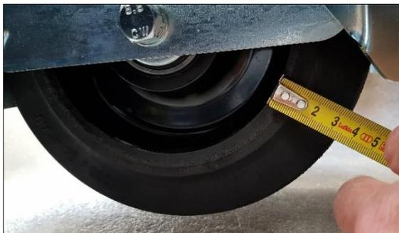
Figura 15: Controllo dell'usura, esempio di misura
