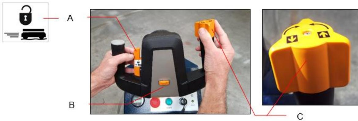
Figura 3: Controllo dello sterzo dell'unità BeTrac 1 AGV
