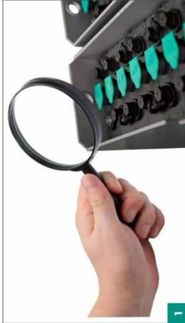
Führen Sie eine gründliche Sichtprüfung durch. Achten Sie besonders auf: Verschmutzung (Staub, Ölverschmutzung u. s. w.), feststehende Schrauben und Verbindungen, eventuelle Beschädigungen des Laddatabels oder Ladesteckers.
