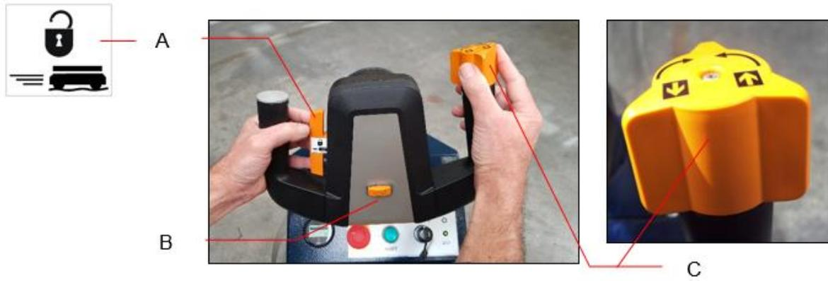
Abbildung 3: Steuer Bedienung BeTrac 1 AGV
