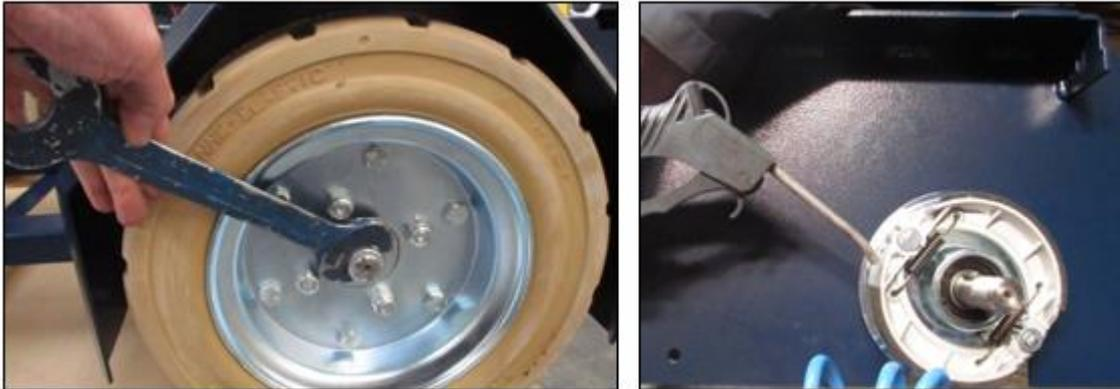
Abbildung 13: Räder demontieren
