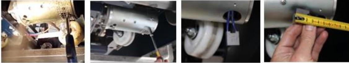
Fig. 7.3 - Ispezione spazzole di carbone del motore
