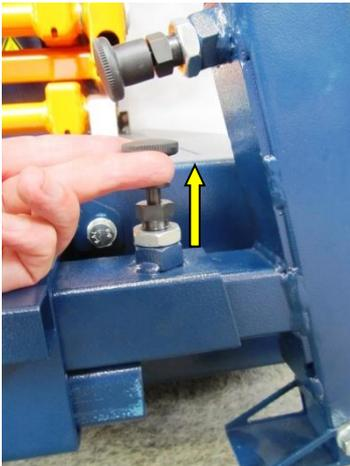
Fig. 2. Rilasciare il perno di blocco stabilizzatore
