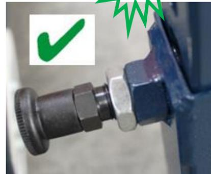
Fig. 4. Bloccaggio del braccio stabilizzatore Bloccaggio ERRATO Bloccaggio CORRETTO
