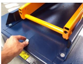
Установка сервисных опор
