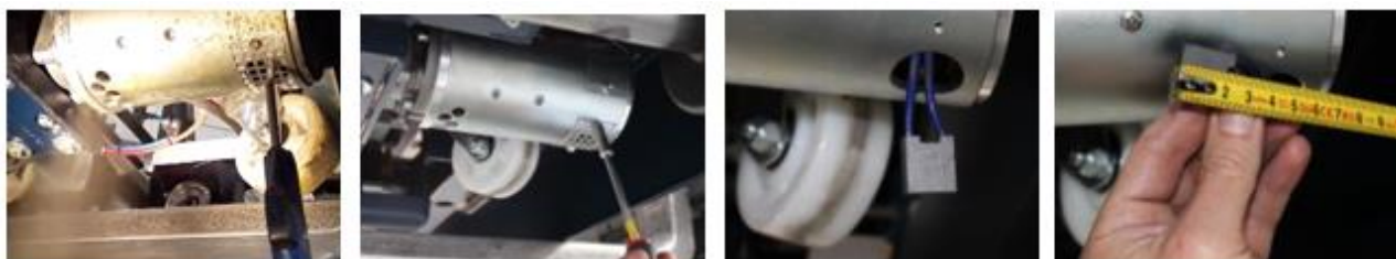
Рисунок 9.4: Контроль щеток электродвигателя
