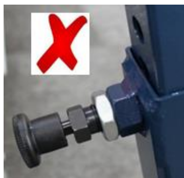
Рис. 4. Зафиксируйте рычаг стабилизатора
