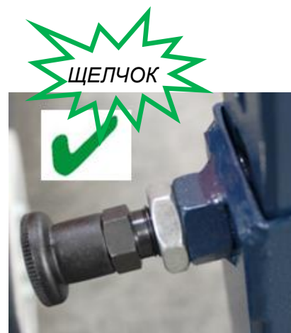
Рис. 3. Вытяните рычаг стабилизатора
