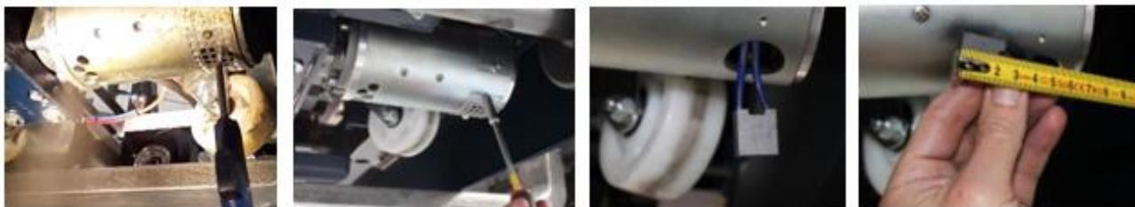
Imagen 7.3 - Inspección de las escobillas del motor
