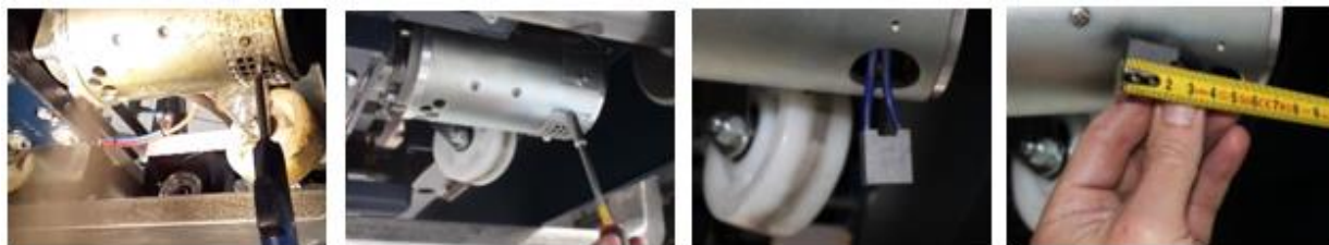
Obr. 7.3 – Kontrola uhlíkových kartáčů motoru
