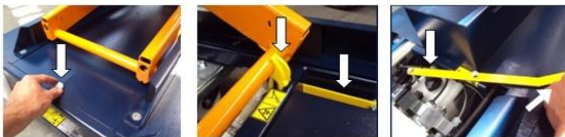
Obr. 6.5 – Vlevo: uvolněte šroub a sejměte kryt. Uprostřed – vytáhněte páku. Vpravo – zatlačte šroub do mezery proti čepu na nouzovém spouštěcím ventilu!
