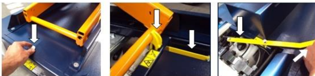
图 6.5——左侧：拧开螺栓并拆下盖子。中间——取出手柄。右侧——将螺栓按入间隙中，使其顶住紧急下降阀中的销！
