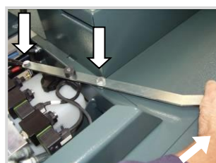
Rys. 6.5; Po lewej: odkręcić śrubę i zdjąć pokrywę. W środku; wyjąć rączkę. Po prawej; śrubę do otworu i przycisnąć do zaworu awaryjnego opuszczania!
