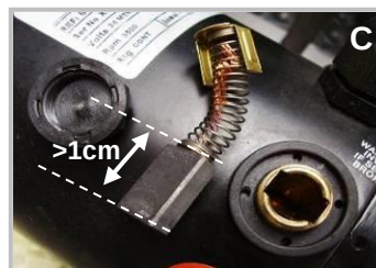
Rysunek 7.3; Wymiana szczotek węglowych do silnika
