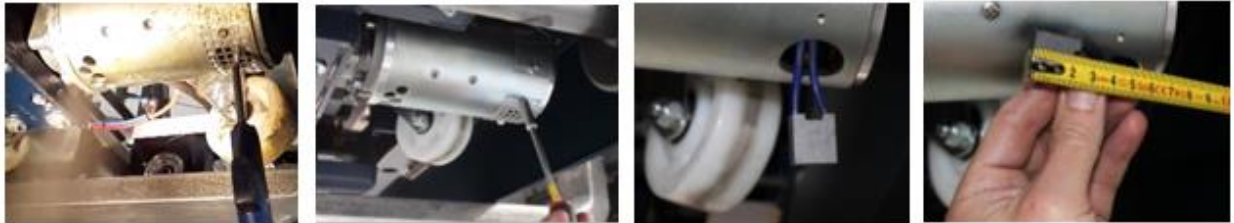
Figuur 9.3 Koolborstels inspecteren
