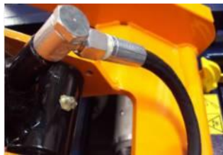
Figura 9.3; Posizione dei nippli di lubrificazione accanto al cilindro
