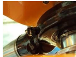
Figura 9.3; Posizione dei nippli di lubrificazione accanto al cilindro
