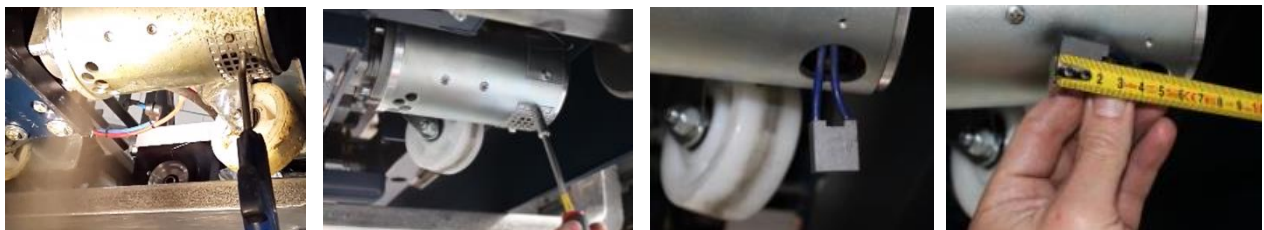
Figura 9.4; Ispezione spazzole di carbone del motore
