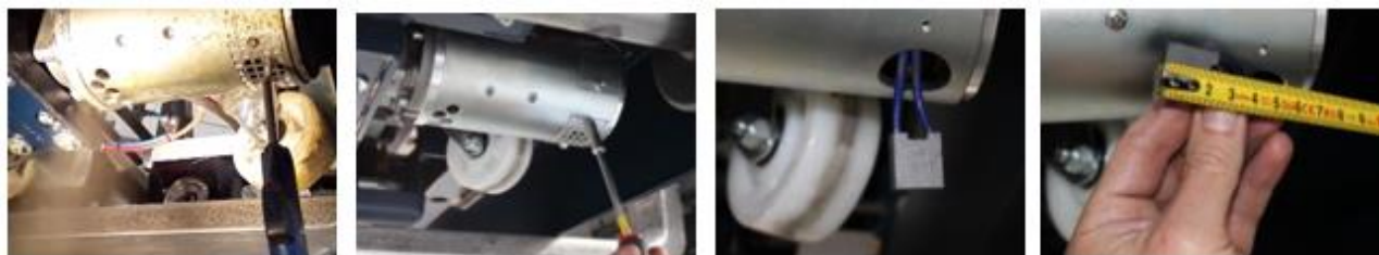
Рисунок 9.4: Контроль щеток электродвигателя
