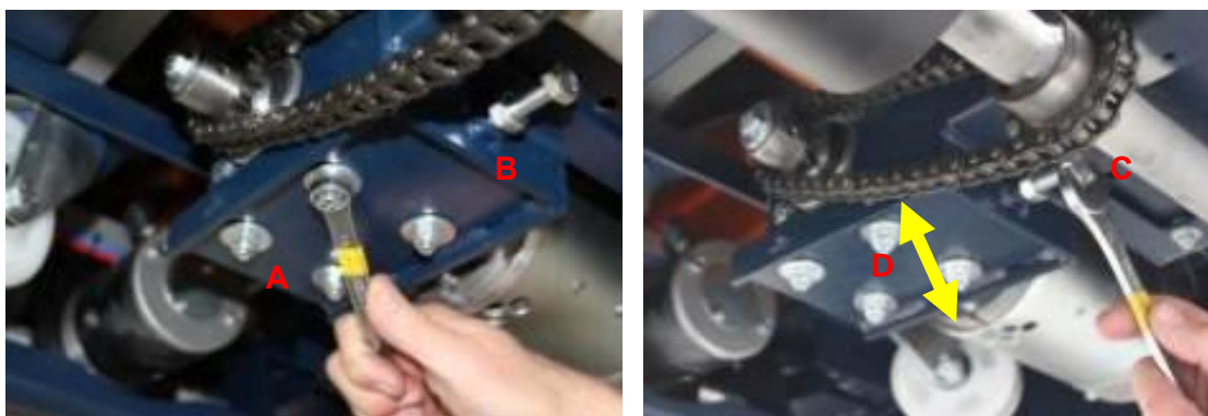
Рис 9.5: A-B-C; Регулировка натяжения цепи
