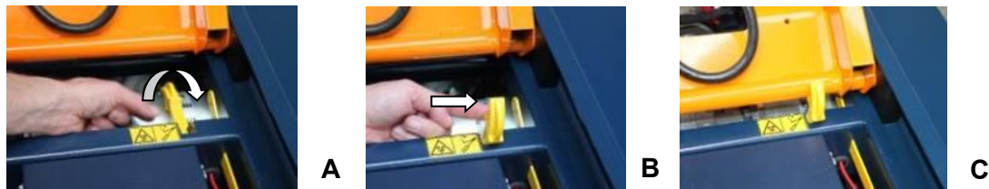
Рис 9.1: А-В-С; Установка сервисных опор
