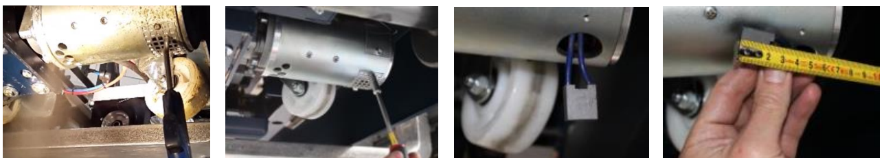
図 9.4; モーターのカーボンブラシの点検
