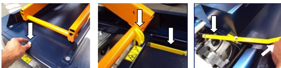
Fig. 8.4; Izquierda: desenroscar el tornillo y retirar el tapón. Medio; gancho de seguridad hacia arriba y quitar la palanca. Derecha: ¡Pulse el botón hacia dentro y el botón contra la clavija de la válvula de descenso de emergencia!
