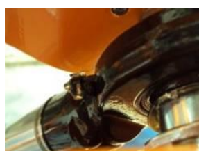
Figura 9.3; Posición de las boquillas de engrase en el cilindro
