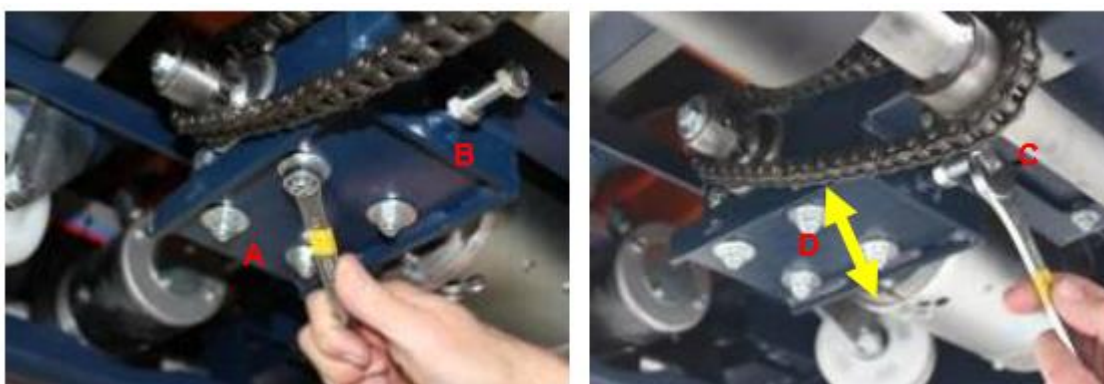
Figura 9.5 A-B-C; Tensión de la cadena
