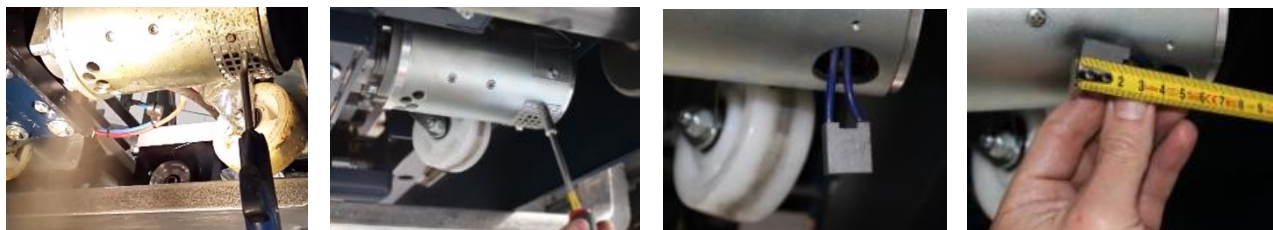
Obrázek 9.4 – Kontrola uhlíkových kartáčů v motoru
