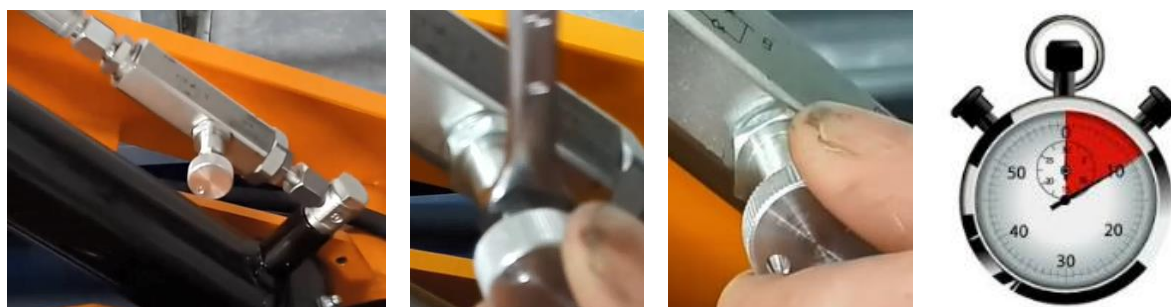
Obrázek 9.6: Nastavení rychlosti spouštění plošiny nůžkového mechanismu
