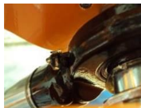
Obr. 9.3 – Umístění maznic na hydraulickém válci
