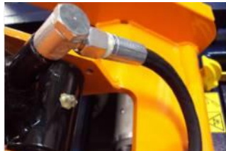
Obr. 9.3 – Umístění maznic na hydraulickém válci
