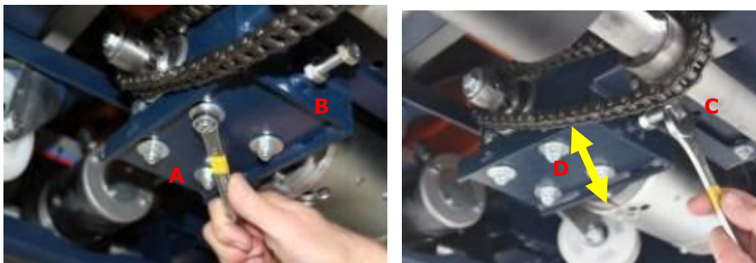
Obrázek 9.5 A–B–C – Napnutí řetězu
