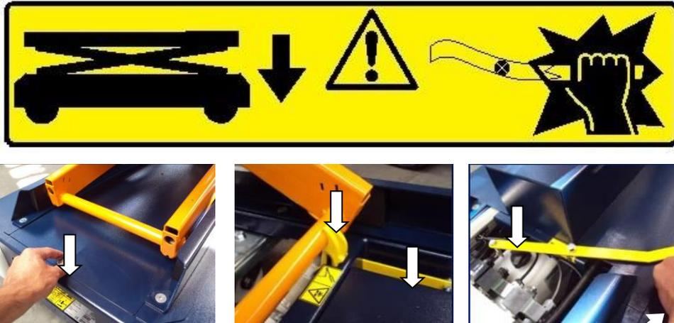
图8.4；左侧：松开螺栓并拆下盖子。中间：升高保险栓并拆下手柄。右侧：将螺栓插入孔中，按压螺栓，使其顶住紧急下降阀中的销！
