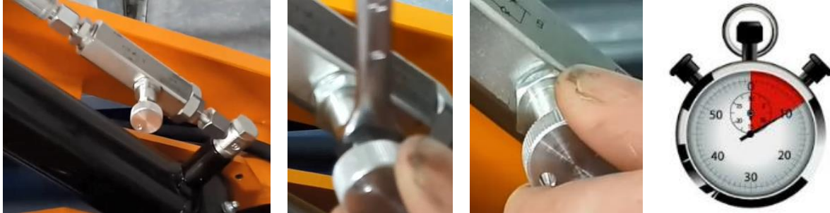
Figuur 9.6; Daalsnelheid schaarplateau afstellen
