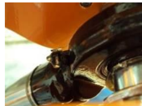
Figuur 9.3; Positie van de smeernippels bij de cilinder
