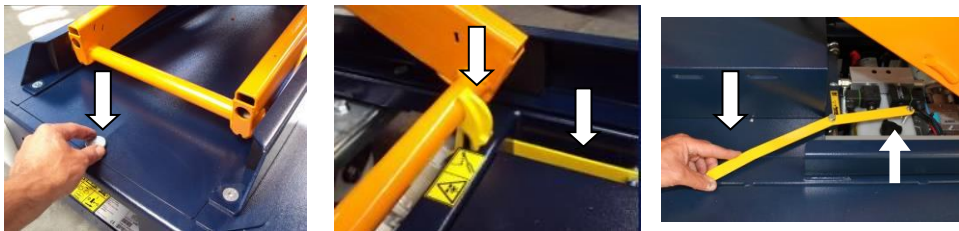
Fig. 8.4; Links: bout losdraaien en kap wegnemen. Midden; veiligheidspal omhoog & hendel uitnemen. Rechts; Bout in gat en bout tegen pen van het nooddaalventiel drukken!!
