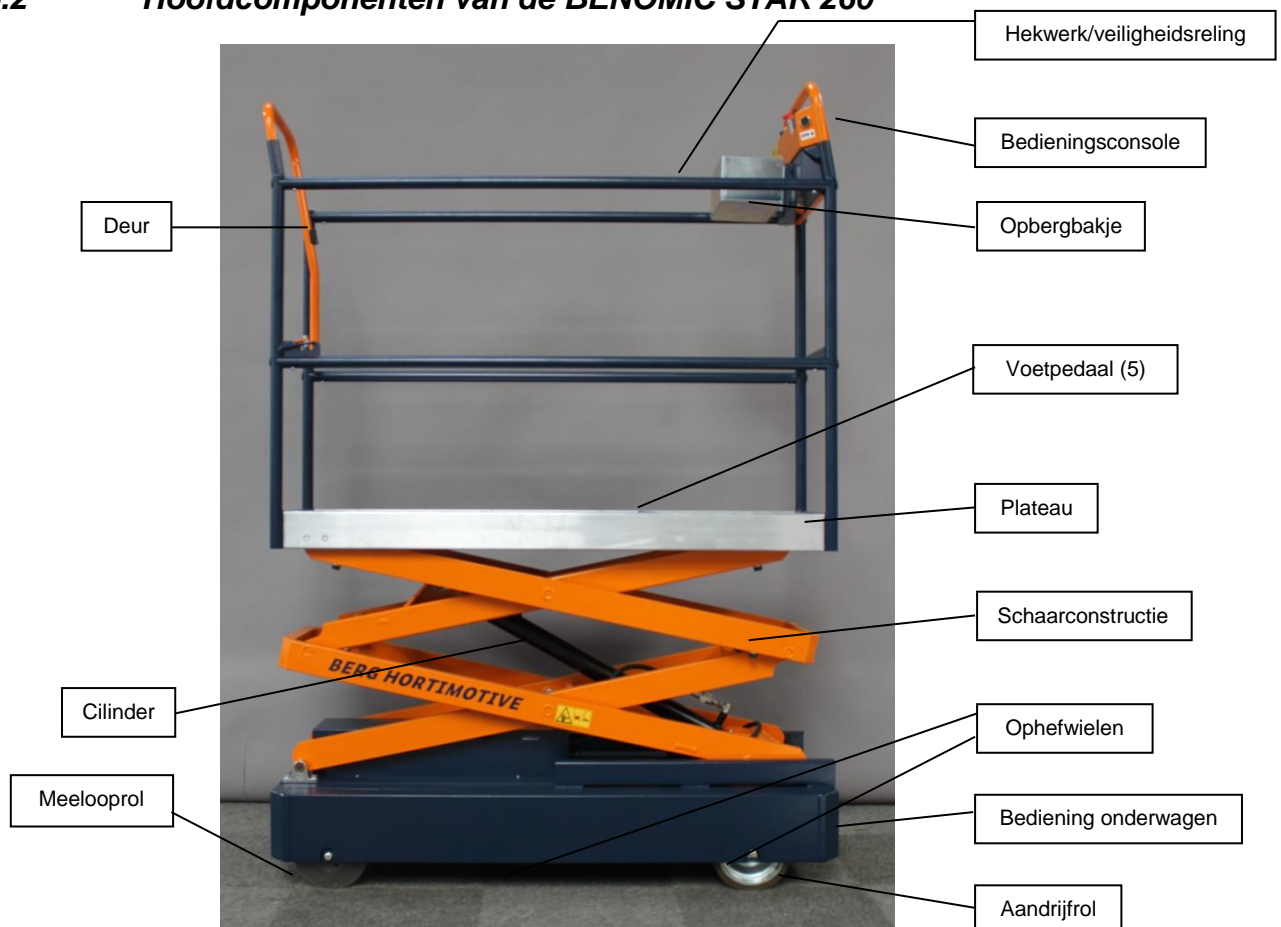
Figuur 5.1; Benaming van de onderdelen aan de bovenzijde van de Benomic STAR 260
