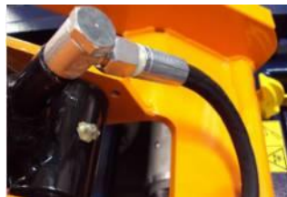
Figuur 9.3; Positie van de smeernippels bij de cilinder
