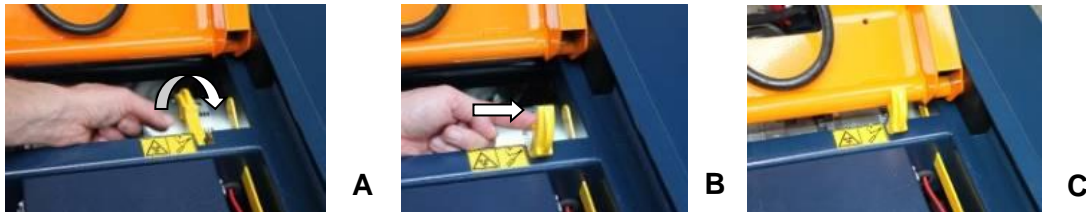
Figuur 9.1 A-B-C; Uitklappen van de schaarblokkering
