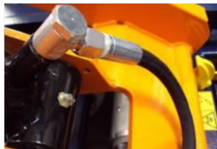
Figuur 9.3; Positie van de smeernippels bij de cilinder
