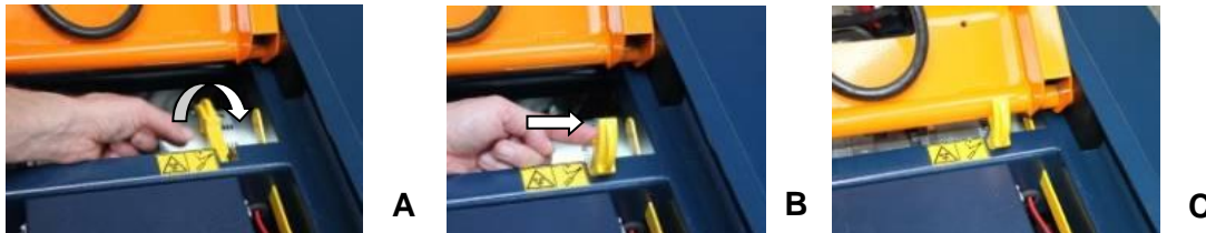
Figuur 9.1 A-B-C; Uitklappen van de schaarblokkering
