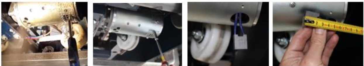
Abb. 9.4; Prüfung Karbonbürsten im Motor
