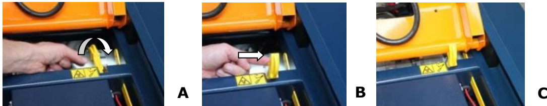
Abb. 9.1 A-B-C; Freigeben der Scherenblöcke
