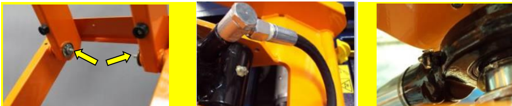
Abb. 9.3; Position der Schmiernippel am Zylinder
