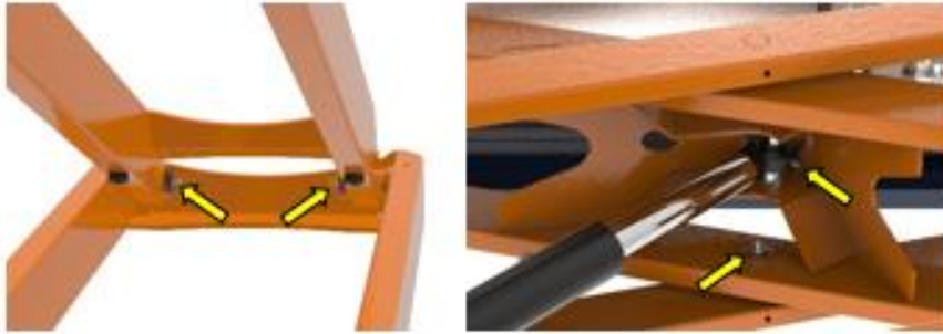
Figure 9.2; Emplacement des graisseurs du pantographe et des arbres de cylindre
