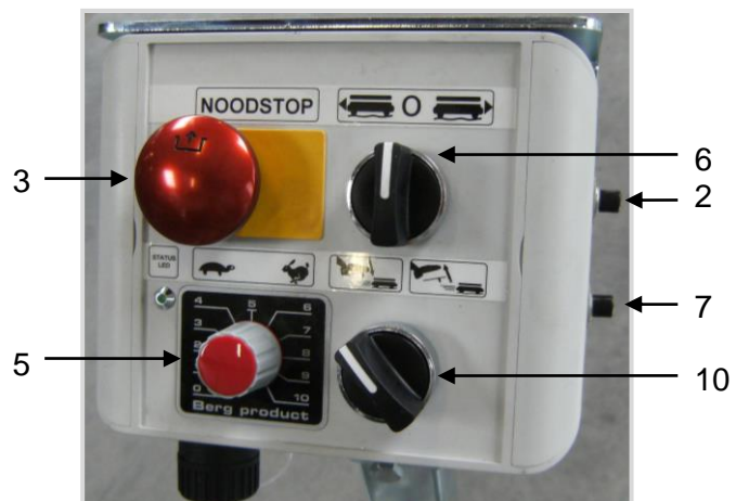
Rysunek 6.1c; słupek sterowniczy, duże przyciski (wyłącznie BRW185)
