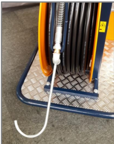
Figura 7.2: Installazione del gancio per tubi
