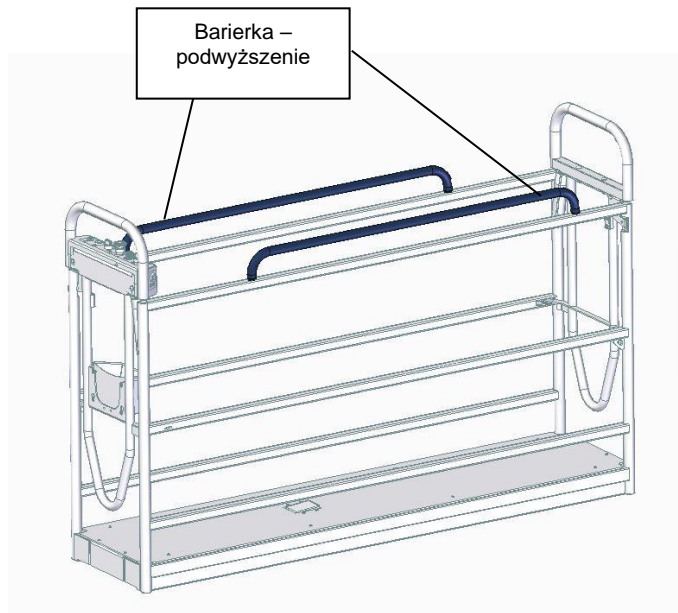
Rysunek 5.1. Nazewnictwo górnej części BENOMIC S
