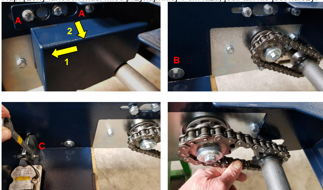
Rysunek 9.5. Napinanie łańcucha
